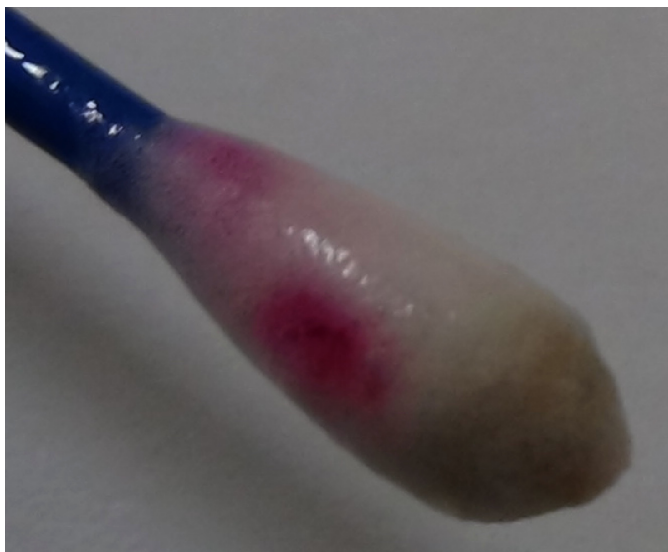
Figura 4. Revelação com reagente de Kastle-Meyer.
